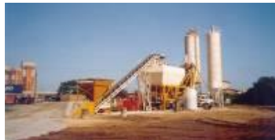
Figura 9. Central dosadora misturadora marca Arcen modelo ARCMOV 80.
