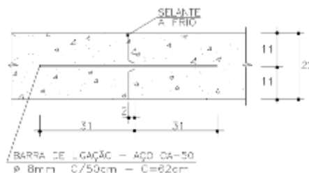
Figura 5 - Detalhe das juntas longitudinais de construção.
